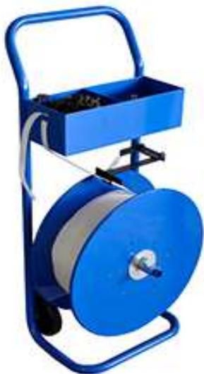
Chariot dévidoir mobile de grande polyvalence et adaptable aux bobines de feuillard de 25, 200, 280 et 406 mm de diamètre au niveau de leur mandrin intérieur.
